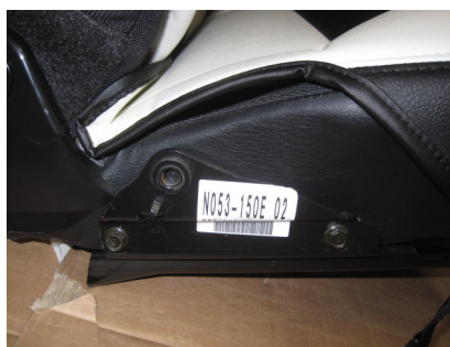
NB8 ベルトアンカー部
